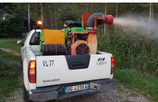
Mezzo dotato di atomizzatore per disinfezione
