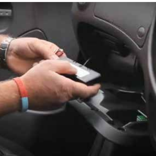
Installazione manuale di una scatola nera
